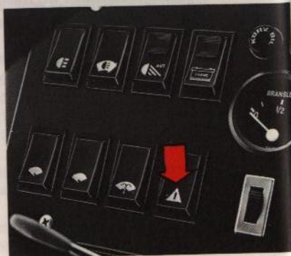
Bild 24. Strömställare för varningsblinkers
