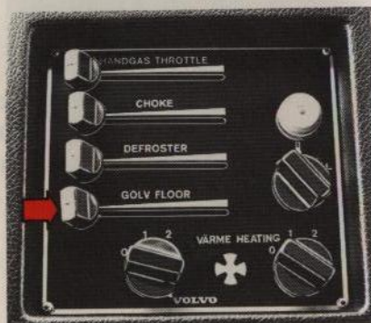
Bild 39. Spak för luftmängd till golv
