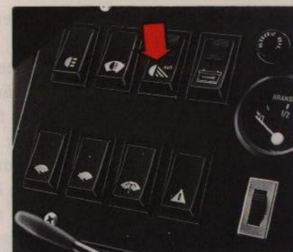
Bild 21. Strömställare för halvljusautomatik
